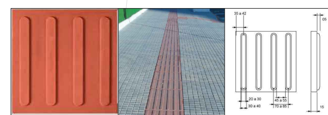
DETALHE PISO TÁTIL SEM ESCALA
