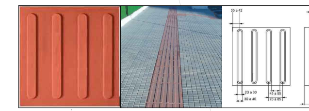
DETALHE PISO TÁTIL SEM ESCALA
